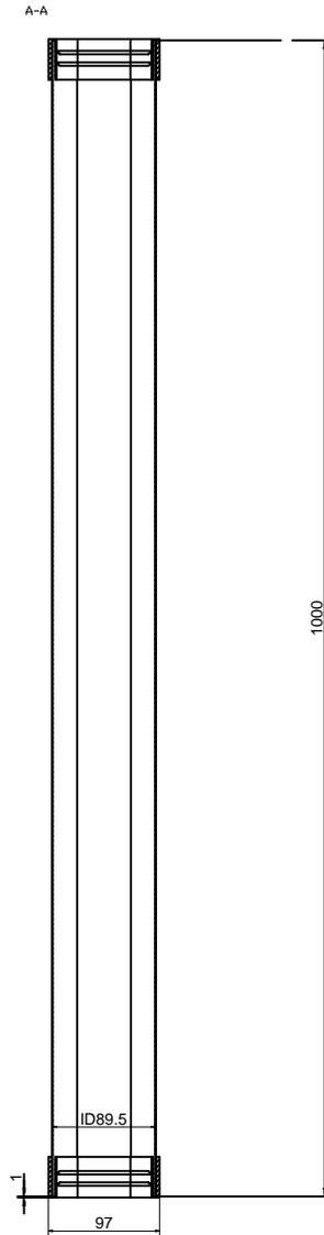
2x Dichtung aus PVC (Artikelnr. 4061027) vormontiert
