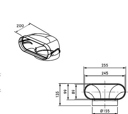
**Planungshinweis:** Zur Verwendung mit Geräten deren Kanalanschluss auf BORA Ecotube (Anschluss 245 × 89 mm) ausgelegt sind. Um BORA Ecotube mit Naber-Anschlüssen (222 × 89 mm) zu verbinden, ist ein Adapter (EFA, 40.001.779, CHF 25.–, exkl. MwSt., siehe Seite 366) verfügbar/separat bestellbar.
